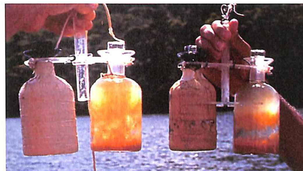
Figura 14.3 Medición de la producción primaria por el método del oxígeno
